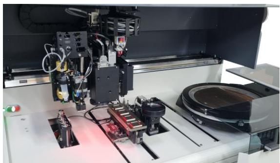
该设备具有独特的粘合层厚度(BLT)控制能力，适用于银玻璃、MEMS和湿片堆叠应用。
