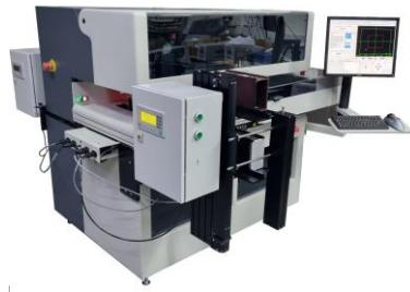
全倒装芯片工艺能力，包括芯片翻转、凹凸磁通和芯片精确对准高分辨率的仰视相机。设备可进行冷热加工，包括：
